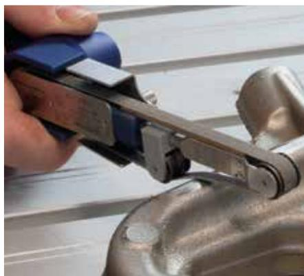
Polierholz mit Diamantpaste und Handfeilmaschine
